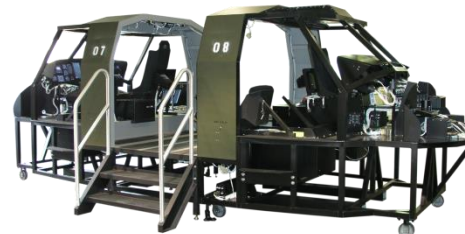
UH-60 Avionic Wiring System Trainer
